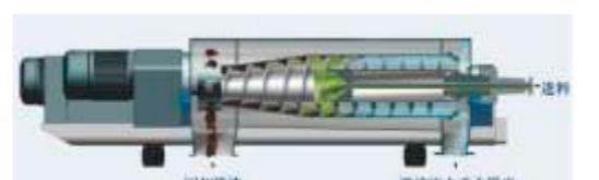
离心脱水机结构示意图
