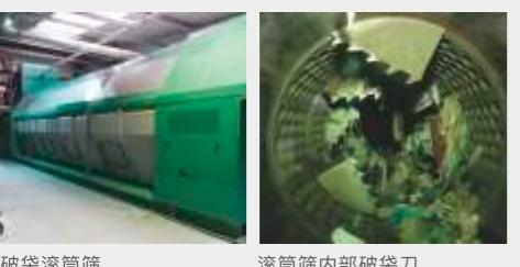
破袋滚筒筛 滚筒筛内部破袋刀
