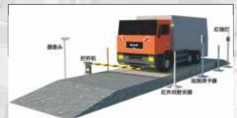
无人值守智能汽车衡计量系统原理图
