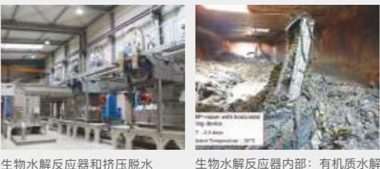
生物水解反应器和挤压脱水 生物水解反应器内部：有机质水解
