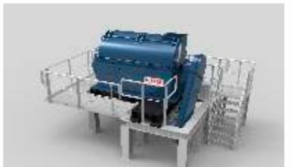
接收料斗中经过沥水的餐厨垃圾经由输送螺旋输送至自动分选机，自动分选机的主要功能是对餐厨垃圾中的塑料、织物及硬质不易破碎的无机物如金属等无机物进行分离，同时通过特殊设计的转锤对餐厨垃圾中的食物残渣进行浆化处理产生有机粗浆料从下部多孔板排出，自动分选产生的无机物通过螺旋输送机输送入存储箱，其主要成分为塑料、金属，外运焚烧。
